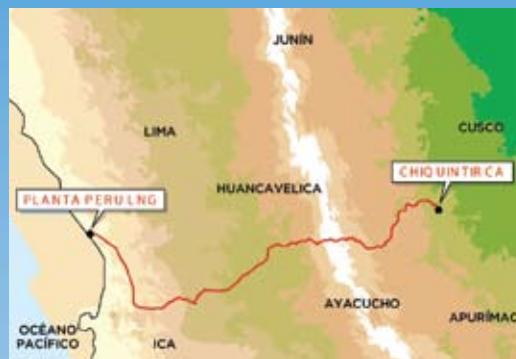
El gasoducto tiene una longitud de 408 km, desde Chiquintirca en Ayacucho hasta la costa. Atraviesa 310 kilómetros de terreno montañoso y 98 kilómetros de planicies desérticas costeras.
